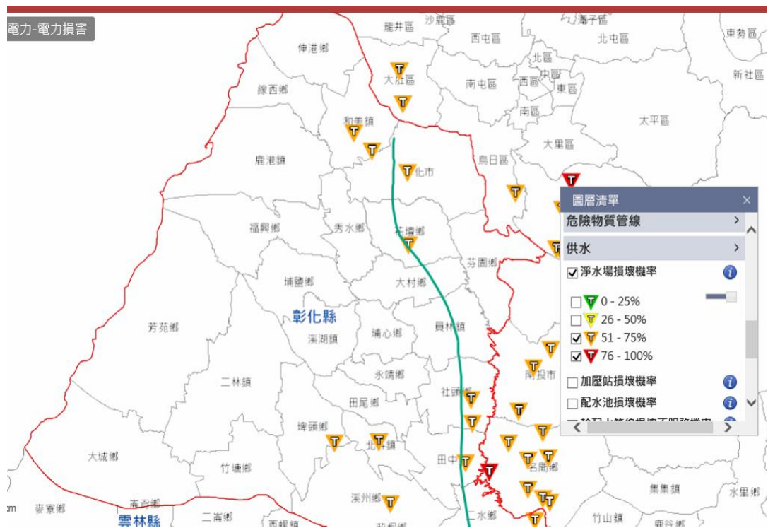
圖 1-3-10 模擬淨水廠損壞機率
